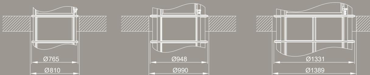
*Diámetros mínimos para perforaciones en instalaciones atravesando forjado.*
